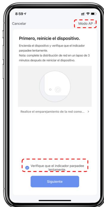
Aparecerá la interfaz de conexión Wi-Fi, ingresará la contraseña wi-fi del teléfono móvil (debe ser la misma que la Wi-Fi del teléfono móvil), haga clic en "Siguiente", aparecerá "Conectar su teléfono móvil al punto caliente del dispositivo" y haga clic en "Ir a conectar";
